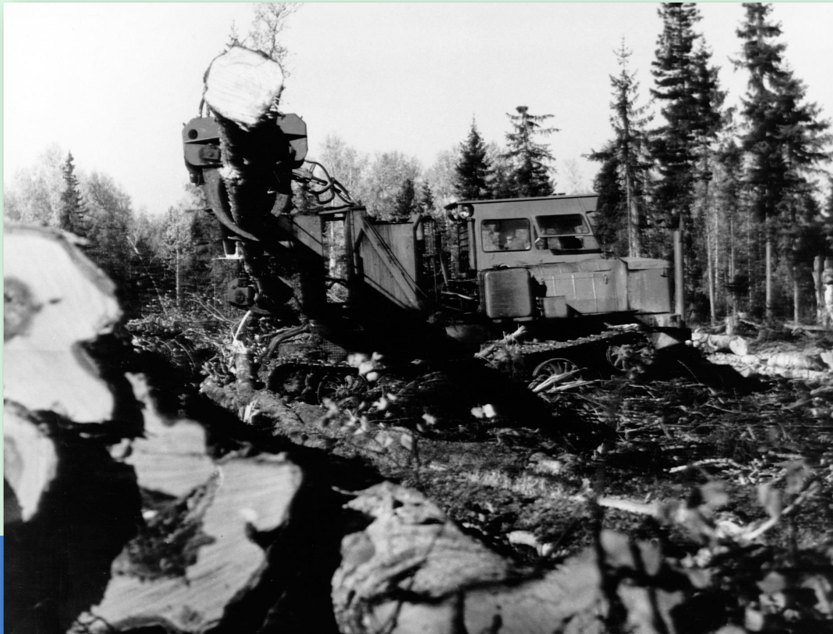
Бобриков С. А. - тракторист Куминского леспромхоза во время работы на безчokerной трелевочной машине марки ЛТ-154, п. Куминский, 1985 год Ф.109. Оп.2. Д.156. Л.1
