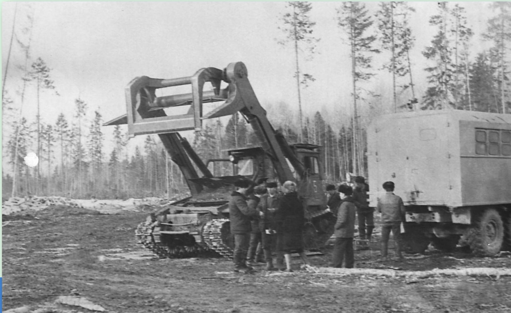
Междуреченский лесопункт. Заготовка леса на деляне (на участке заготовки леса) челюстным погрузчиком ЛТ – 65 , 1969 г. Ф.109. Оп.2. Д.693. Л.1
