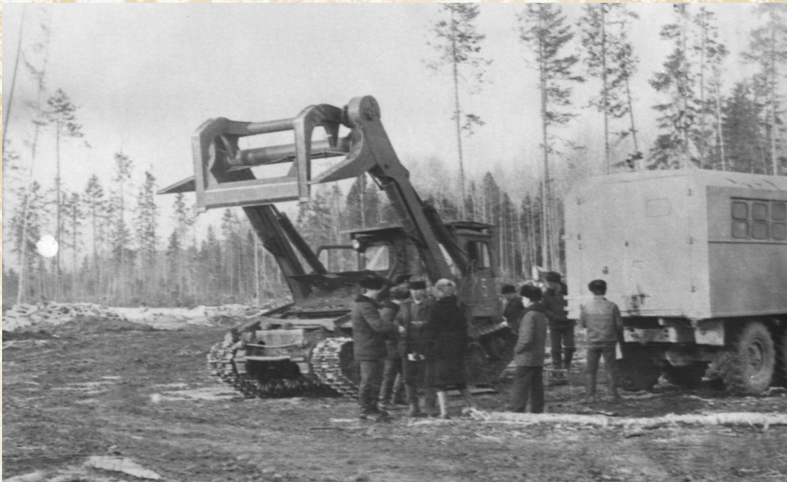
Междуреченский лесопункт. Заготовка леса на деляне (на участке заготовки леса) челюстным погрузчиком ЛТ – 65. , 1969 г.
