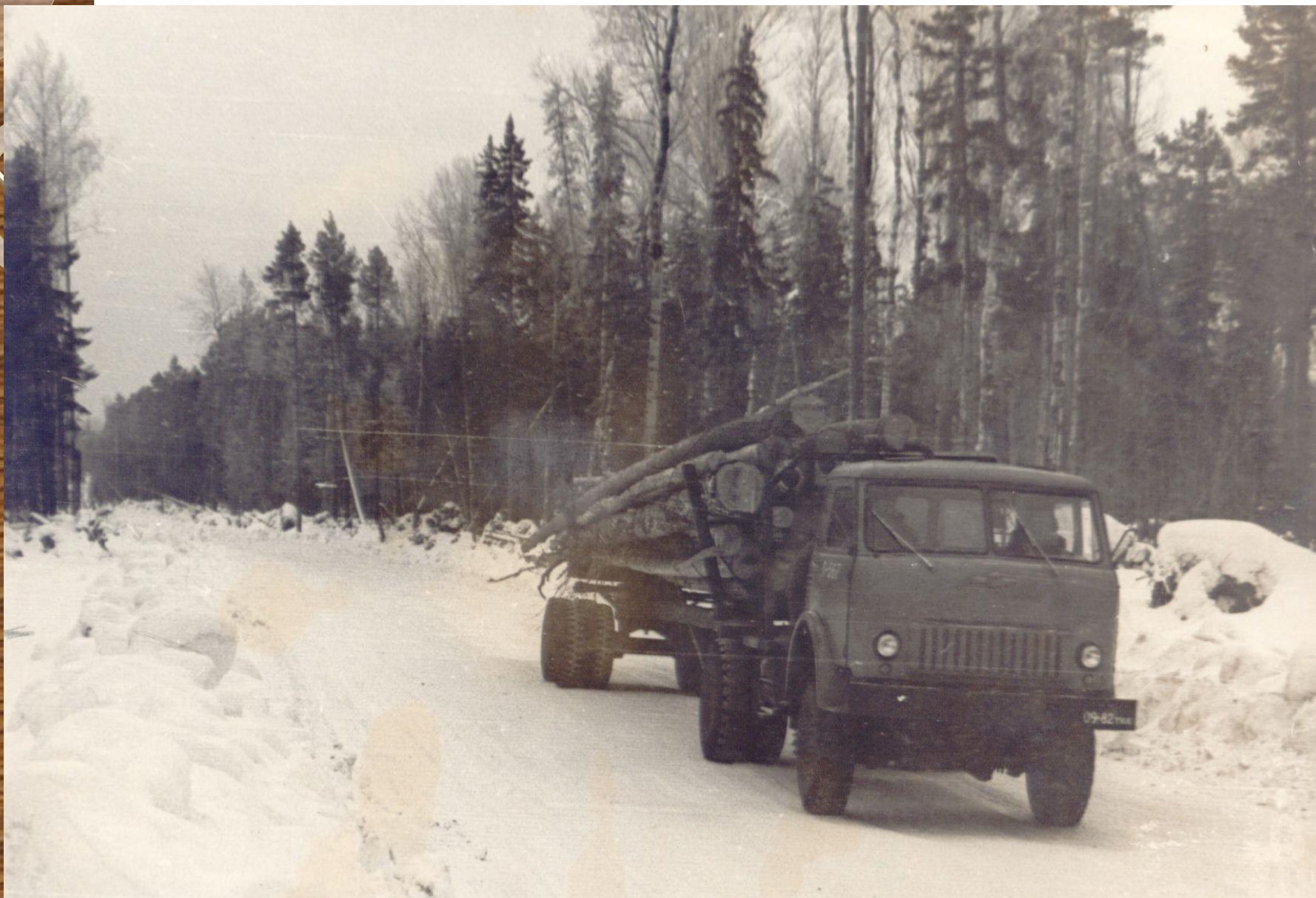
Перевозка леса в хлыстах лесовозной машиной МАЗ-501 Южно-Кондинский ЛЗУ, п. Междуреченский. 1975 г. Ф.109.Он.2. Д.50. Л.1
