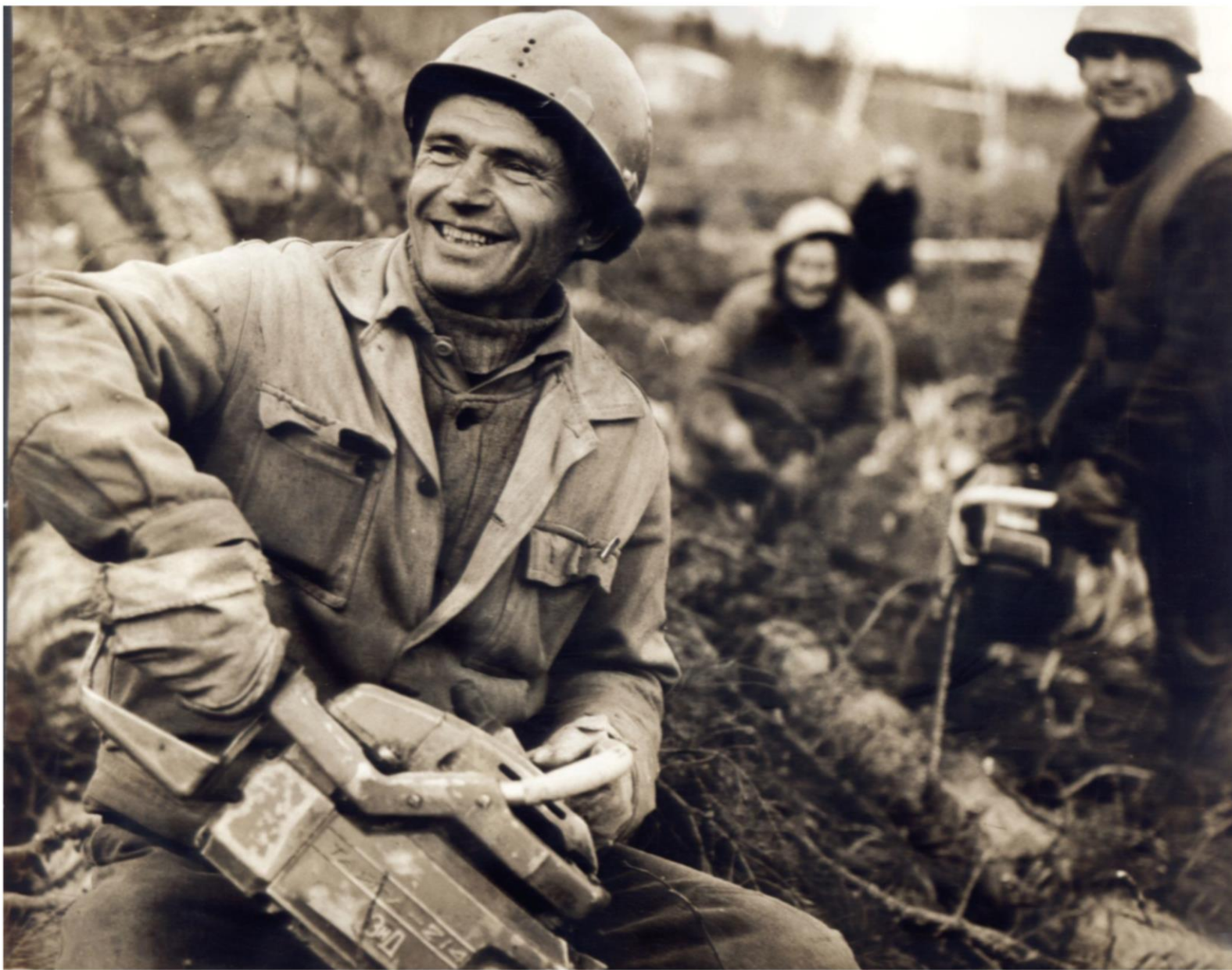
Обработка сучьев ручными бензопилами Тайга-214 в Южно-Кондинском ЛЗУ п. Междуреченский , 1978 г.
