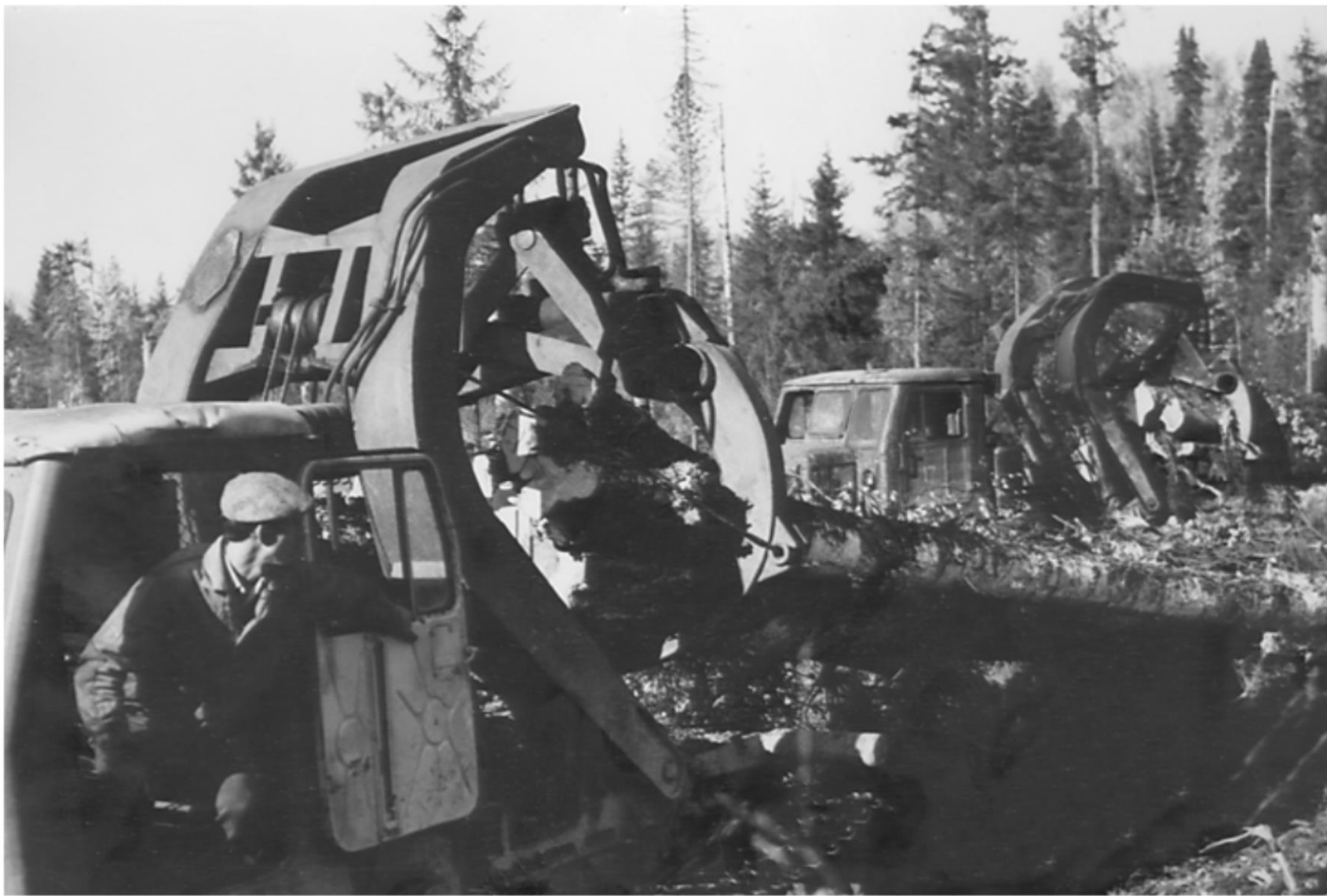
Бобриков С. А. тракторист Куминского леспромхоза во время работы на безчокерной трелевочной машине марки ЛТ-154, п. Куминский, 1985 год
